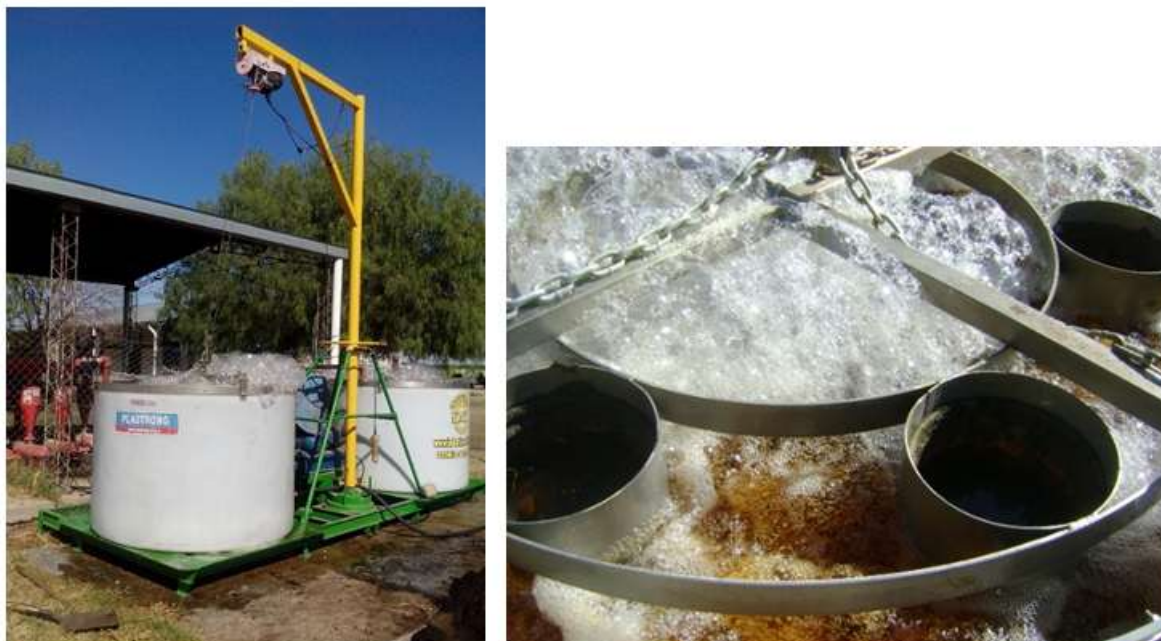
Figura 2. Biorreactor de compost para la obtención de abono líquido a partir del compost de alperujo. Frutos del Norte SA., Pomán, Catamarca. Vista completa (izquierda); tolva, cilindros con compost sólido sumergido en agua en agitación (derecha).
