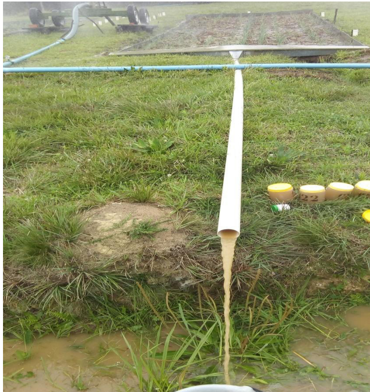
Figura 1. Calha conectada a um tubo de PVC de 75 mm de diâmetro e 6 m de comprimento com a função de direcionar o escoamento superficial.
