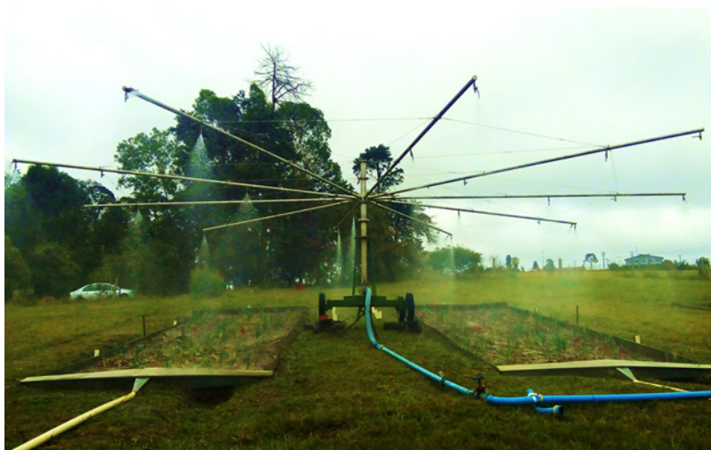
Figura 2. Aparelho Simulador de chuva de braços rotativos do tipo Empuxo operando sobre duas parcelas simultaneamente.
